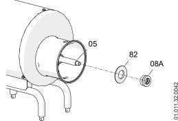
3. Colocar el paragotas (82) y la parte estacionaria del cierre mecánico doble (08A) en el eje (05).
