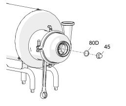
3. Inmovilizar el eje (05) colocando una llave fija entre los planos.
